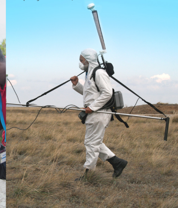
Ejercicio integrado de inspección in situ realizado por la OTPCE en Semipalatinsk (Kazajistán) (medición del campo magnético terrestre).
