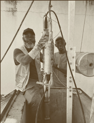
Sismomètre obsolète retiré d’un puit à la station sismologique auxiliaire AS97, à Babate (Sénégal)
